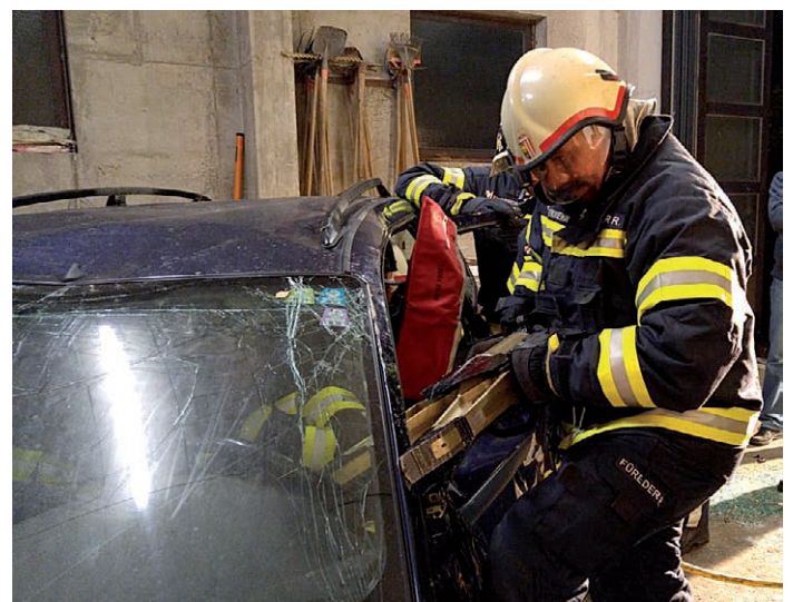
Füreder Robert versucht mit dem Spreitzer die Lenksäule in eine Stellung zu bringen bei der eine schonende Bergung möglich ist.
